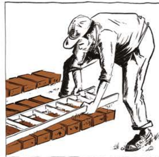
LES BRIQUES SONT DÉMOULÉES ET LAISSÉES À SÉCHER SUR DE VASTES SURFACES.
