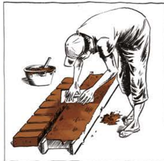
UN MOULE EN BOIS AVEC UNE OU PLUSIEURS ALVÉOLES EST REMPLI AVEC LE MÉLANGE.
