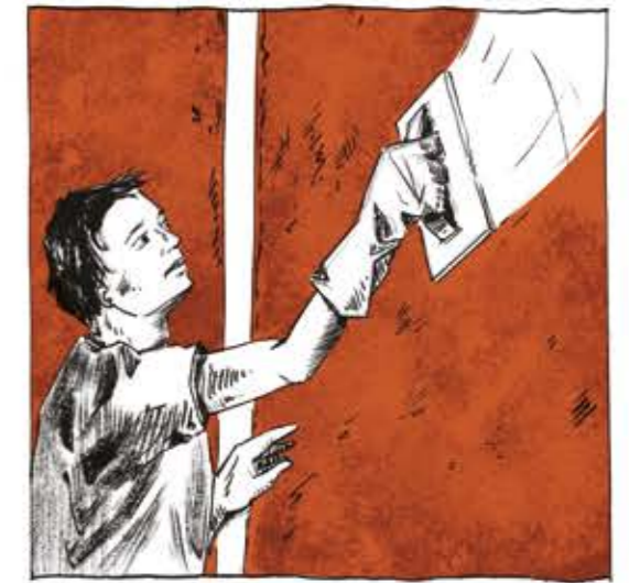
UN ENDUIT EN TERRE, PARFOIS STABILISÉ À LA CHAUX AÉRIENNE, EST APPLIQUÉ LORSQUE LE MUR EST SEC.
